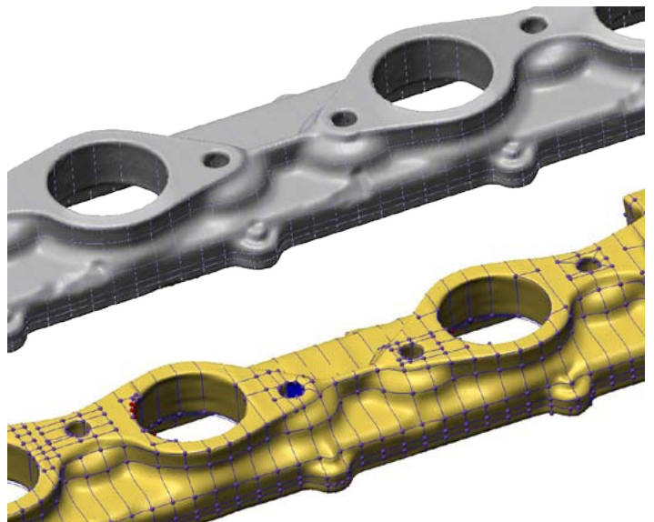
Für die Gewinnung von NURBS-Flächen lassen sich Schnitte auf das Polygon legen. Nach dem Export der Schnitte als Kurven, erzeugt PolyWorks zwischen ihren Schnittpunkten Flächen-Patches, die Basis für das spätere CAD.
