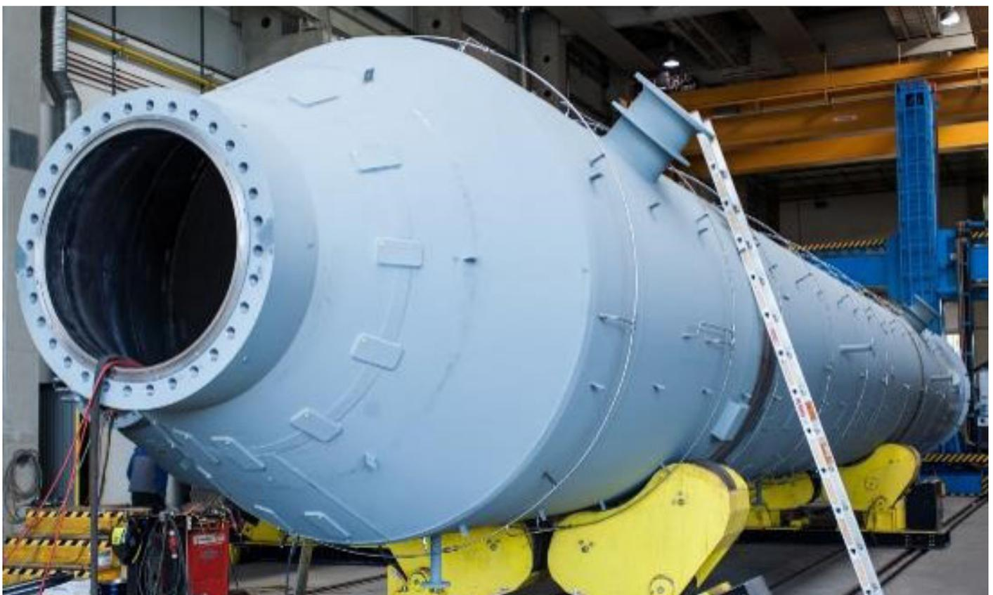
Oxidationsreaktor einer Nassoxidationsanlage
