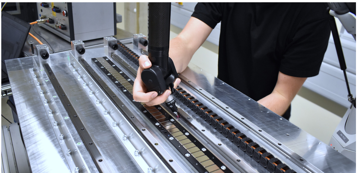
Einstellung der Manipulation mit dem Hexagon® Romer Absolute Messarm
