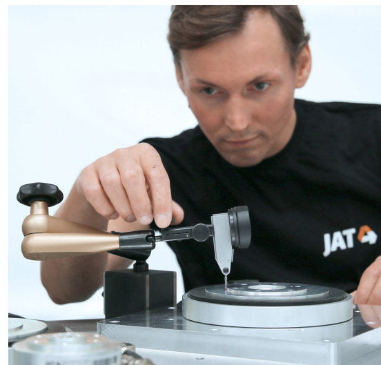
Vermessung eines Rundtischsystems der HRT-Reihe
