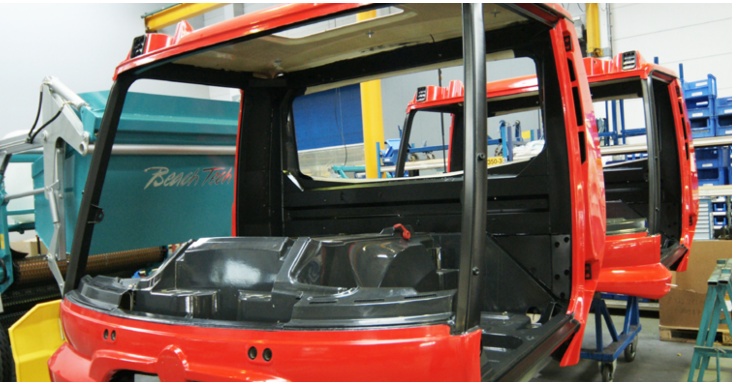
Montiertes Fahrerhaus inklusive GFK-Anbauteilen
