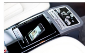
IndiKar Portfolio: Innenausbauten, Prototyping, Messeauftritte, ... iPhone-Halter mit automatischer Aufstellmechanik.
