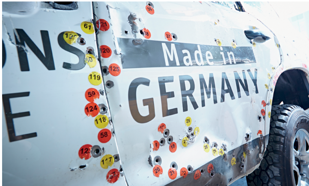
Für das Zertifikat einer Beschussklasse ist eine zerstörende Prüfung notwendig. Höhere Beschussklassen beinhalten auch Sprenganforderungen. Dieses Fahrzeug hat die Klasse VR7 ("Vehicle Resistance") bestanden.
