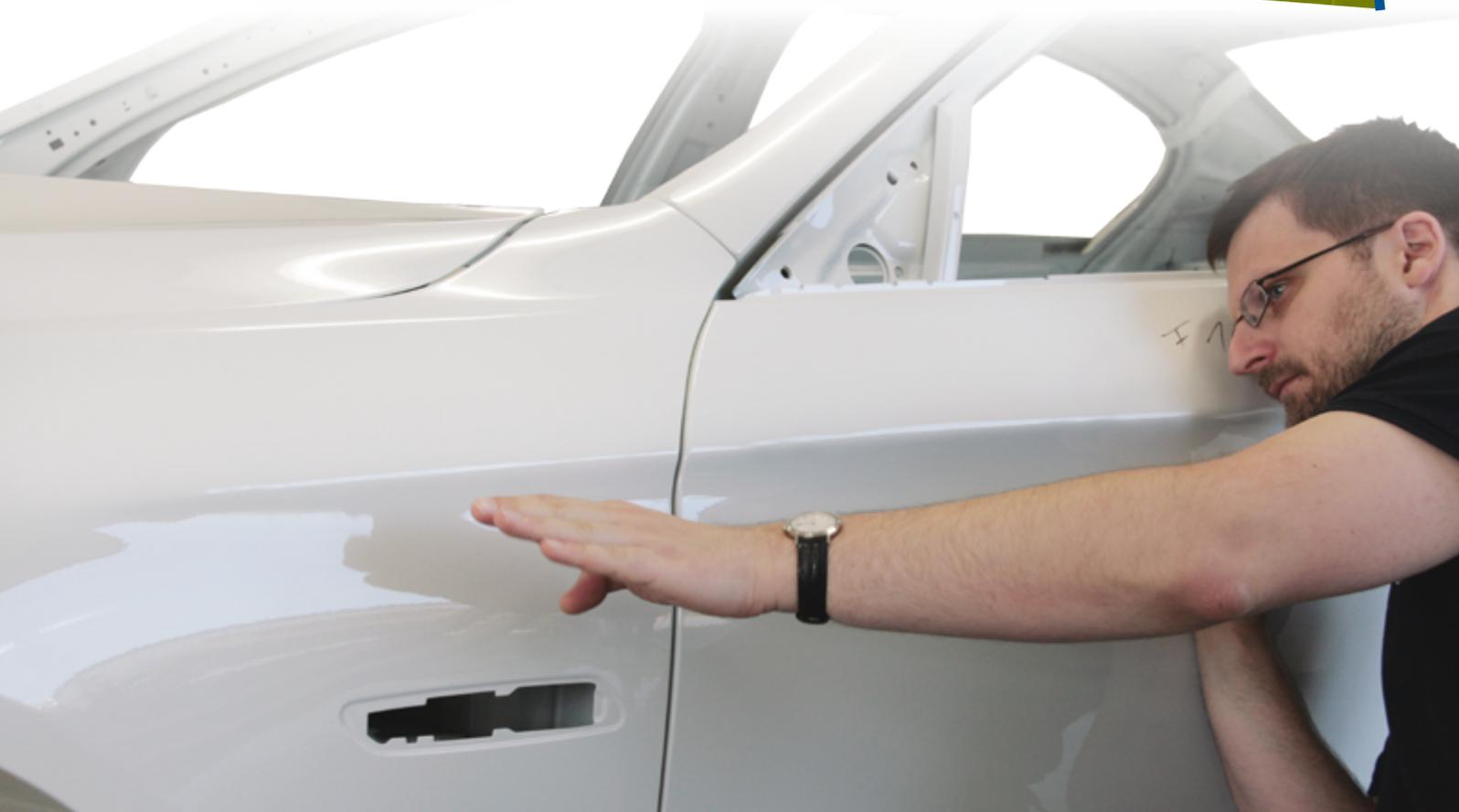
sarmes zu verändern und somit das Gesamtfahrzeug in einem einheitlichen Koordinatensystem zu erfassen. Durch Verwendung der Plug-In-Funktion für den FARO-Arm im PolyWorks/Inspector™ wird sowohl die optische wie auch die taktile Messmethode unterstützt. Um die Tornadolinie zu erfassen, wird der Laserscanner benutzt. Die taktile messende Einheit des FARO-Arms wird zum Einmessen in eine neue Position des Messarmes verwendet.
